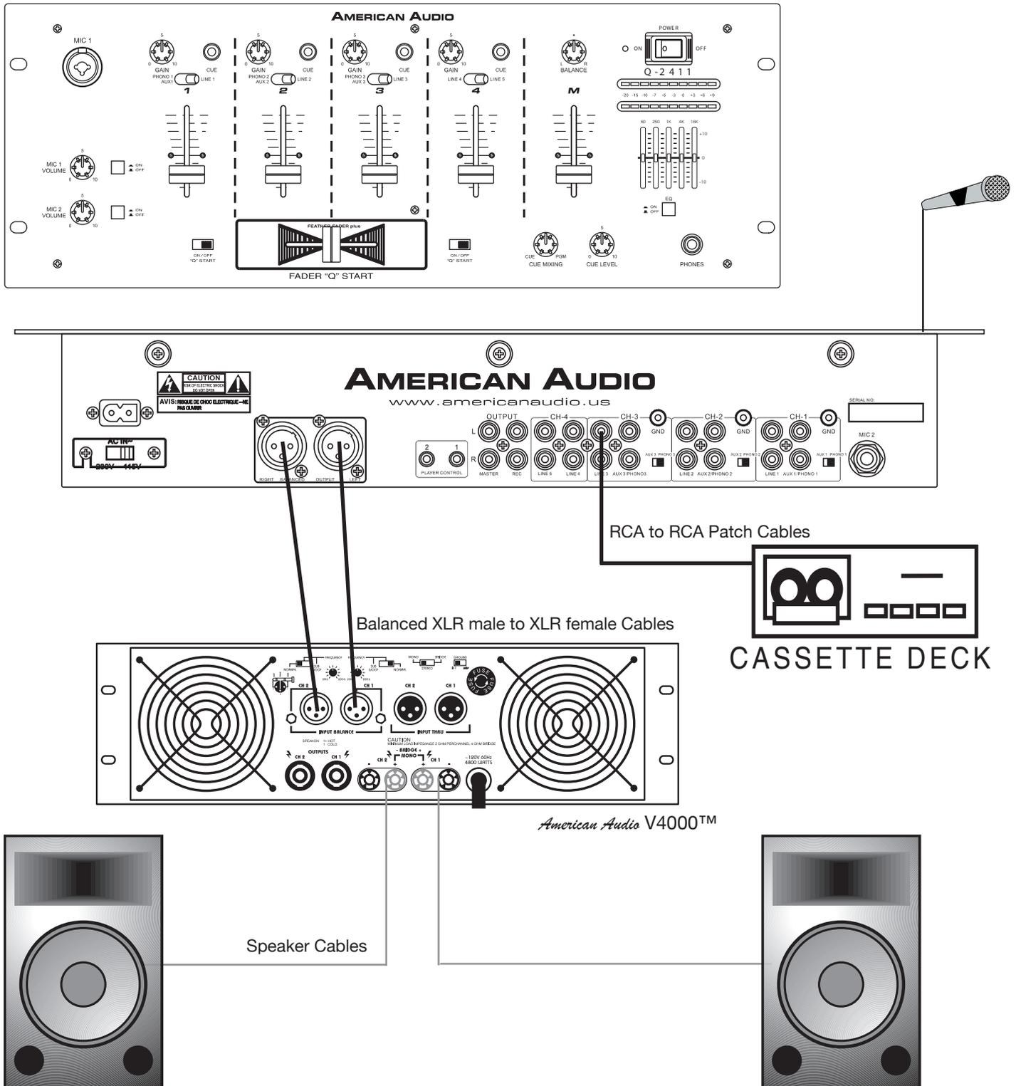
Instalación de una salida balanceada tipo
