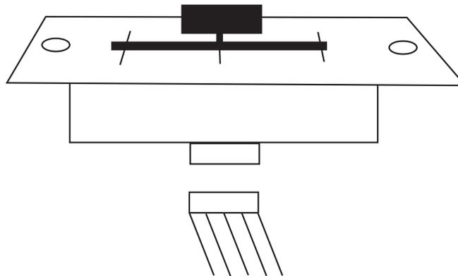
El desvanecedor es “Hot Swapable” (puede conectarse en caliente), lo que significa que puede ser reemplazado en cualquier momento, aún estando conectado al suministro eléctrico. Utilice exclusivamente el repuesto Feather Plus de American Audio. La utilización de cualquier otro modelo de fader puede dañar seriamente la mezcladora.
