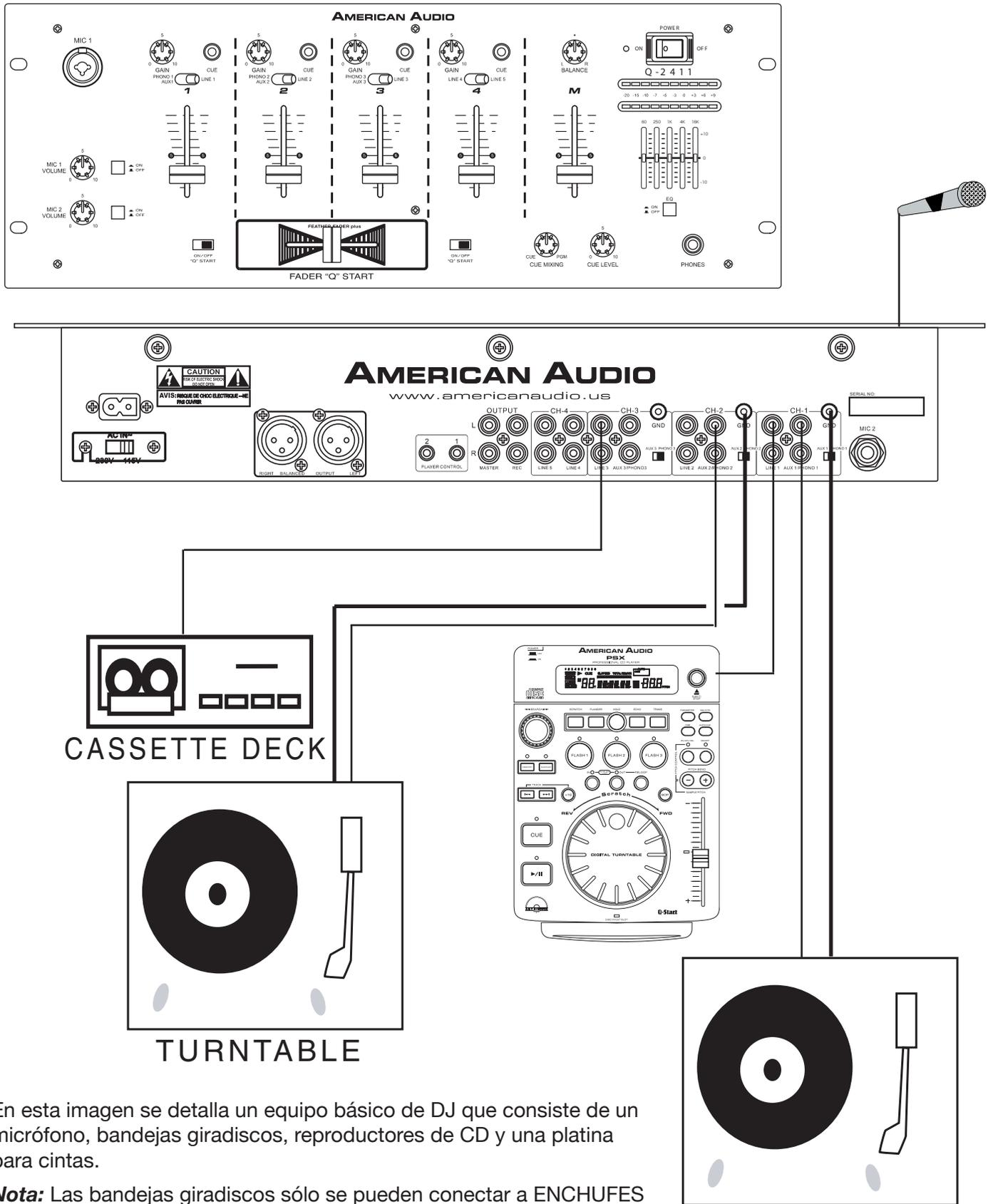
En esta imagen se detalla un equipo básico de DJ que consiste de un micrófono, bandejas giradiscos, reproductores de CD y una platina para cintas.
