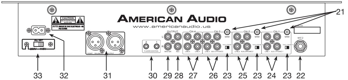
**21. GND (TERMINAL A TIERRA)** – Asegúrese de conectar cables a tierra para bandeja giradiscos a una o a las dos terminales a tierra disponibles. Esto reducirá los zumbidos y estallidos asociados con los cartuchos phono magnéticos.
