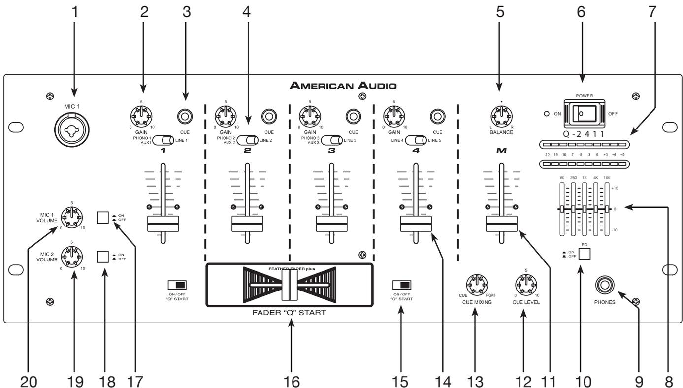
**1. MICRÓFONO 1** – Este enchufe combo acepta un enchufe estándar de 1/4 o un XLR balanceado de tres clavijas. EL NIVEL DE SALIDA DE VOLUMEN PARA ESTE MICRÓFONO SE CONTROLA MEDIANTE SU PERILLA DE CANAL RESPECTIVA (20). Nota: Para obtener la mejor calidad de sonido, recomendamos utilizar un micrófono de 500-600ohm.
