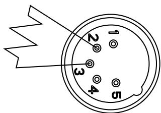
Un terminateur DMX512 réduit les erreurs de signal, évitant la plupart des interférences de réflexion du signal. Connectez la broche 2 (DMX-) et la broche 3 (DMX+) du dernier appareil en série avec une résistance de 120 Ohm, 1/4 W pour terminer le DMX512.
