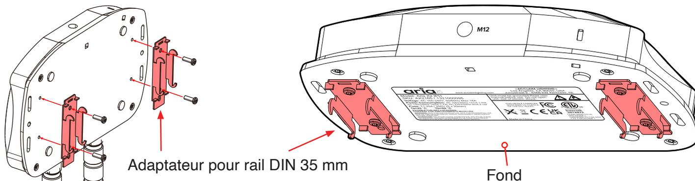
2. Montez l'émetteur-récepteur Aria X2 en alignant les adaptateurs de rail DIN 35 mm avec les fentes du rail DIN 35 mm. Faites glisser l'émetteur-récepteur Aria X2 sur le rail jusqu'à ce qu'il s'enclenche ou se verrouille en place.
