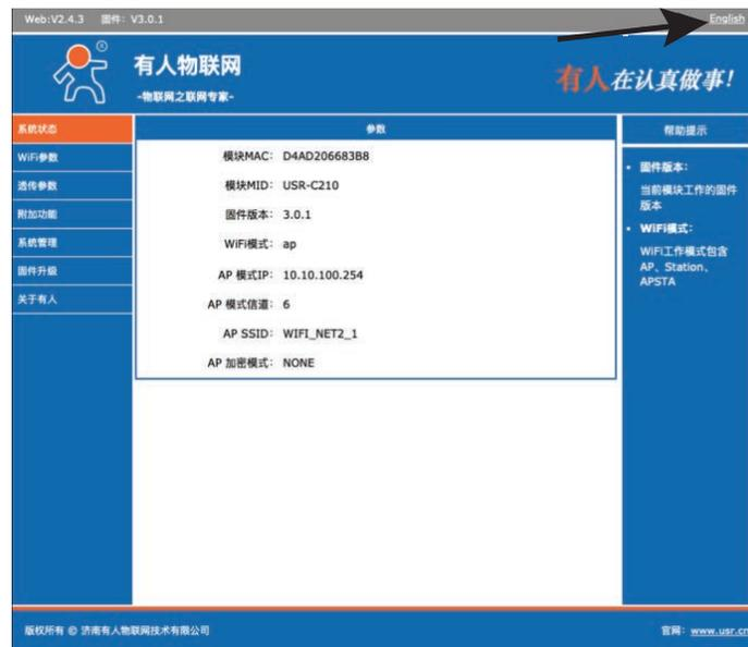
5. Cliquez sur l'onglet Paramètres WiFi sur le côté gauche de l'écran (1). En mode de travail WiFi, sélectionnez « Mode AP+STA » dans le menu déroulant (2), puis appuyez sur le bouton « Rechercher » situé sous l'en-tête « Mode STA » (3).
