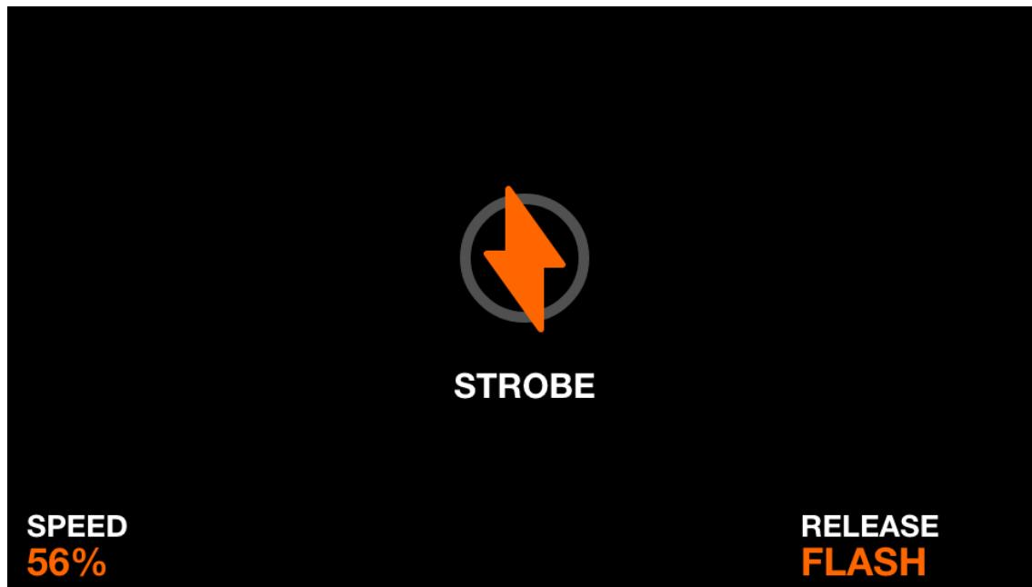
El efecto Flash Estrobo hace que todas las luminarias parpadeen activando la función de estrobo de los dispositivos. Si la luminaria no dispone de una función de estrobo incorporada, se creará un estrobo virtual mediante el parpadeo de los canales RGB o del dimmer. El efecto se libera según el modo de liberación configurado.
