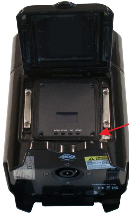
3. Une fois le panneau de l'écran d'affichage retiré, la batterie de couleur bleue doit être clairement visible. Localisez les deux fils blancs qui partent de la batterie et reliez-les à un fil rouge et à un fil noir via un petit connecteur blanc. Débranchez le connecteur, puis retirez la batterie et remplacez-la par une nouvelle unité.
