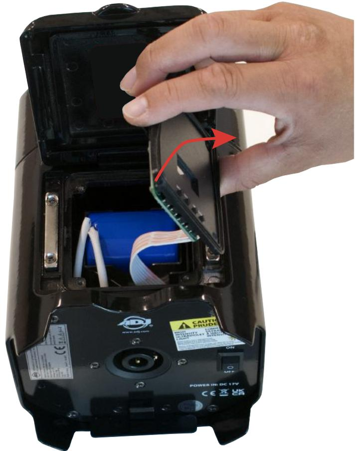
1. Éteignez l'appareil et débranchez-le de l'alimentation. Soulevez le panneau de couverture sur le côté de l'unité, exposant le panneau avec l'écran de commande. Utilisez un tournevis pour retirer les quatre vis situées dans les coins du panneau de l'écran d'affichage.
